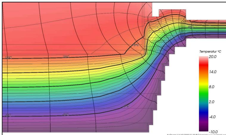
Abbildung 157: Fenstereinbau Vorderkante Mauer 5 cm Rahmenüberdämmung – 15°Leibung – POS 3 – Stromlinien und Isolinien – Detail
